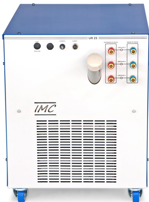
Figura 10 - unidade de refrigeração UR23.
