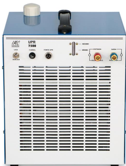
Figura 10.1 - unidade de refrigeração UPR7500
